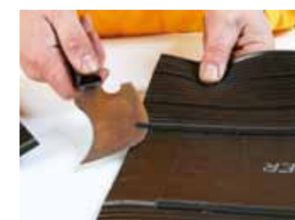
Przygotowania do wykonania zakładu
