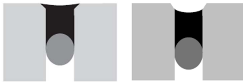
Wypełnienie szczeliny na płasko zmniejsza ryzyko potykania się i zapobiega zbieraniu się brudu
