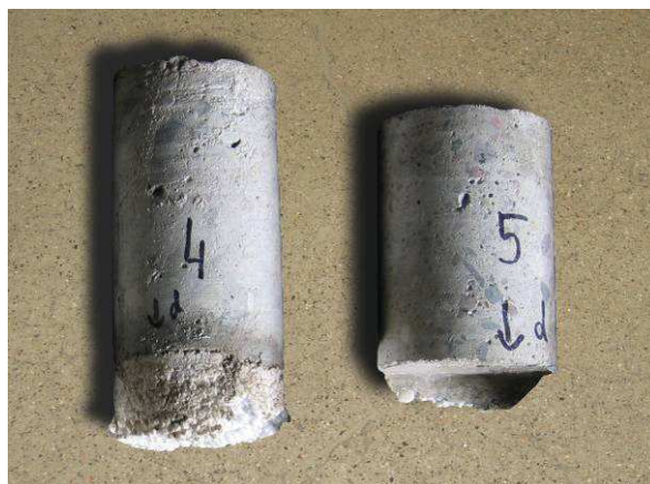
Rys. 21. Pustki powietrzne na pobocznicach walców wyciętych z podkładu posadzki
