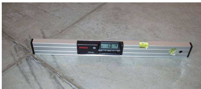
Rys. 9. Pomiar lokalnego nachylenia powierzchni przy narożu dylatacji poziomica elektroniczną
