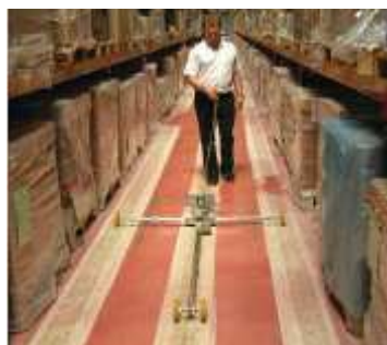
Rys. 9. Pomiar lokalnego nachylenia powierzchni przy narożu dylatacji poziomica elektroniczną
