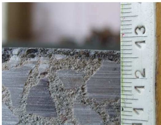
Rys. 57. Pomiar grubości warstwy utwardzonej na wyciętej próbce rdzeniowej
