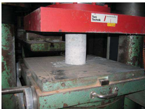
Rys. 12. Badanie wytrzymałości próbki w maszynie wytrzymałościowej
